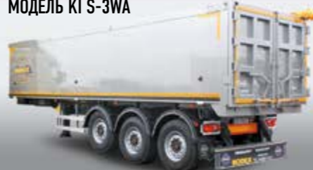
САМОСВАЛЬНЫЙ АЛЮМИНЕВЫЙ ПОЛУПРИЦЕП-ЗЕРНОВОЗ BODEX, V=45 М.КУБ. МОДЕЛЬ KI S-3WA
