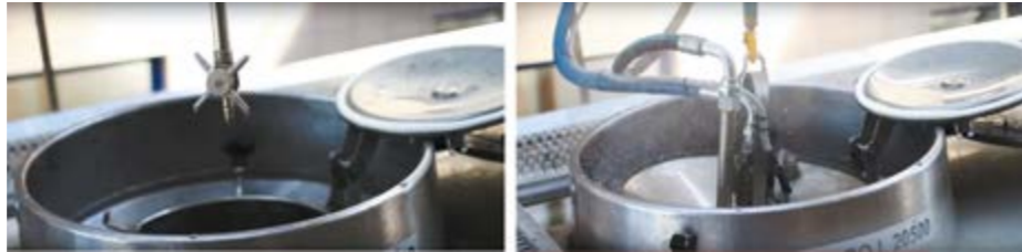
■ фото № 11: Стационарные мойки тщательно вымывают и обрабатывают паром пищевые цистерны, не оставляя «мёртвых» зон.
