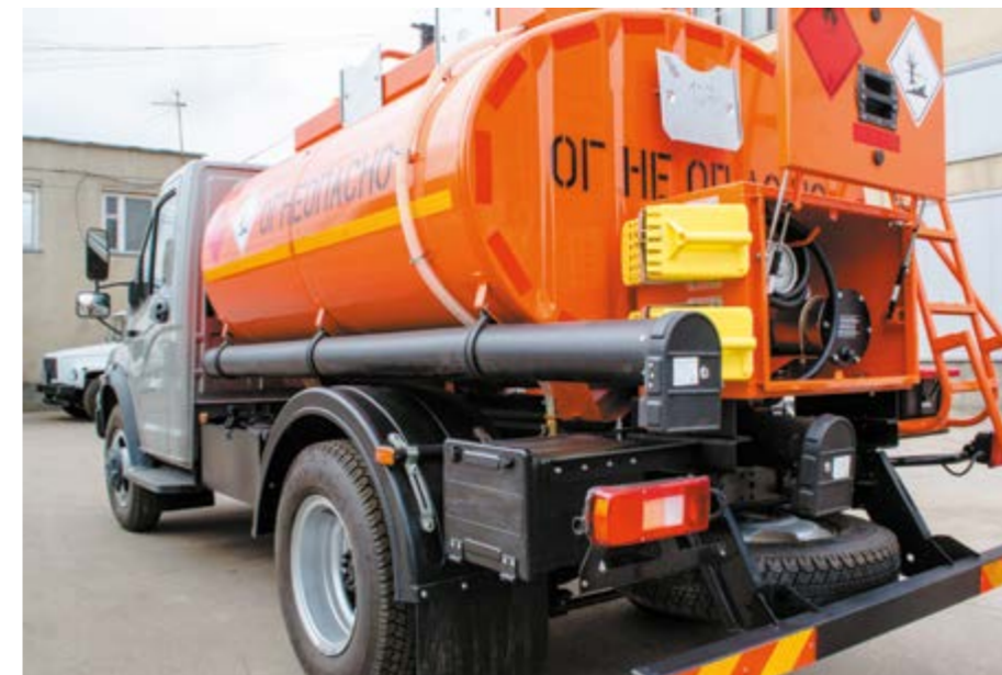
■ Узел выдачи топлива в АТЗ «Рустрак» по ходу движения автомобиля, что позволяет оперативнее производить заправку автомобилей как с левой так и с правой стороны
