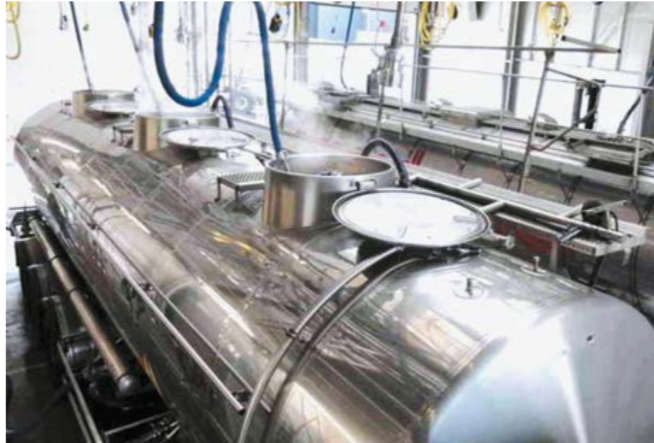
■ фото № 12: В лучших образцах пищевых «термосов» внутренний объём делится на 3 или 4 секции. В каждой секции можно транспортировать различные жидкие грузы, причём температура для каждой секции может устанавливаться и контролироваться автономно.
