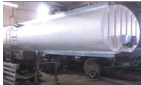
■ фото № 8: Автоцистерны, утепленные материалом Тепломет от компании Теплоинвест, перевозят патоку при начальной температуре продукта +15°C и наружной -35°C. Изоляция помогает сохранять тепло 5 часов без подогрева
