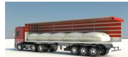
■ фото № 14: Флекситанк – это эластичный резервуар, удерживающий жидкость собственной конструкцией. Флекситанки перевозят различными видами транспорта, включая морские контейнеры и автомобильные полуприцепы.
