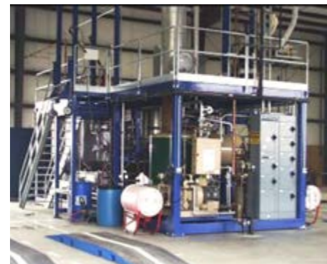
■ фото № 10: Американская компания KMT International Inc. предлагает модульную систему автоматической санитарной мойки, рассчитанную на мойку одной или сразу двух цистерн. В различных вариантах комплектации производительность мойки может составлять от 15 до 40 цистерн в сутки
